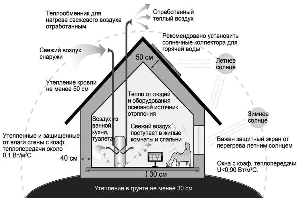
Рис. 1. Схема функционирования «Пассивного дома» [3]
