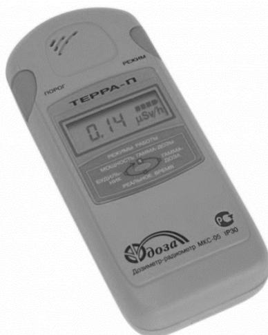
Рис. 3. Мобильный цифровой дозиметр MKC-05 Terra-P
