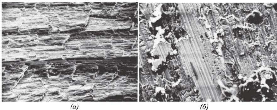
*Рис. 3. Поверхность стали У8ГА при механической обработке (с использованием электронного микроскопа, увеличение в 100000х)
