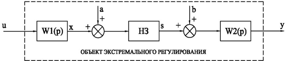
Рис. 1. Структурная схема одномерного объекта экстремального регулирования
