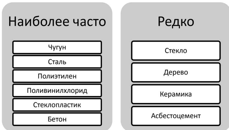
Рис. 1. Материалы, из которых изготавливают канализационные трубы
