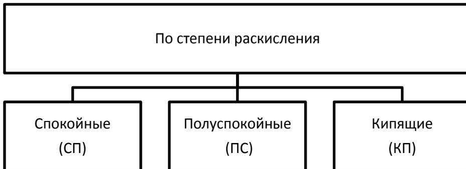
*Рис. 2. Классификация сталей по степени раскисления*
