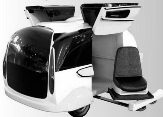
Рис. 3. Выдвижной роликовый механизм
