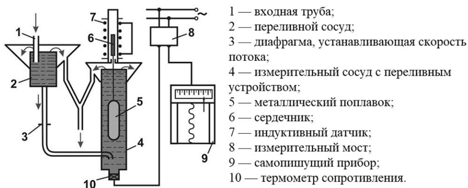
Рис. 1. Схема поплавкового плотномера
