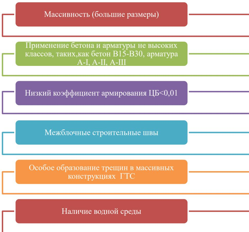
Рис. 1. Особенности железобетонных конструкций ГТС
